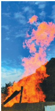
鄂西页岩气24H井震旦系陡山沱组页岩气压裂试气点火放喷,火焰高度10余米。(据《北京日报》)
