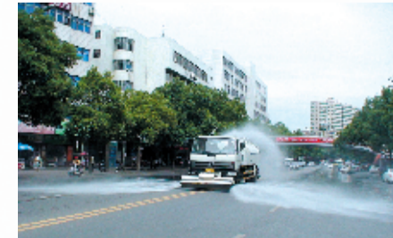
雾喷降尘、冲洗道路
