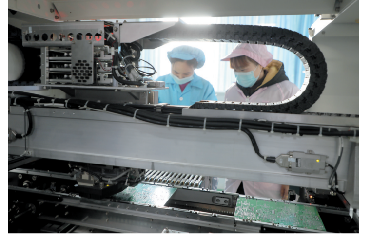
工人们正生产新能源汽车电源控制线路板
