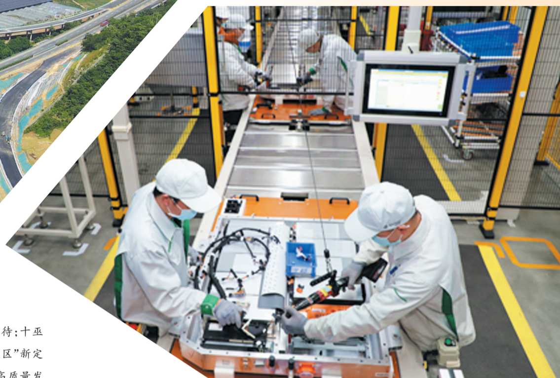
远景零碳智能电池产业园首条商用车插电式动力 pack 组装线顺利实现量产
