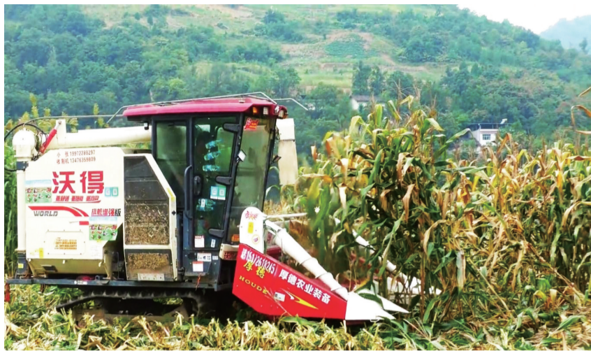
曾经，秋收时节人倍忙。如今，“上午地里谷，中午袋里粮”已成普遍现象。郧西海涛农机服务专业合作社负责人郑海涛介绍，采用谷物联合收割机收割作物，不仅能提高收割效率，机器在收割的同时还能将秸秆粉碎在田里，有利于下一茬作物播种作业，也解决了秸秆利用问题。
