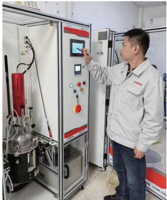
王勤操作共沉淀反应釜，用于合成电池材料前驱体。
