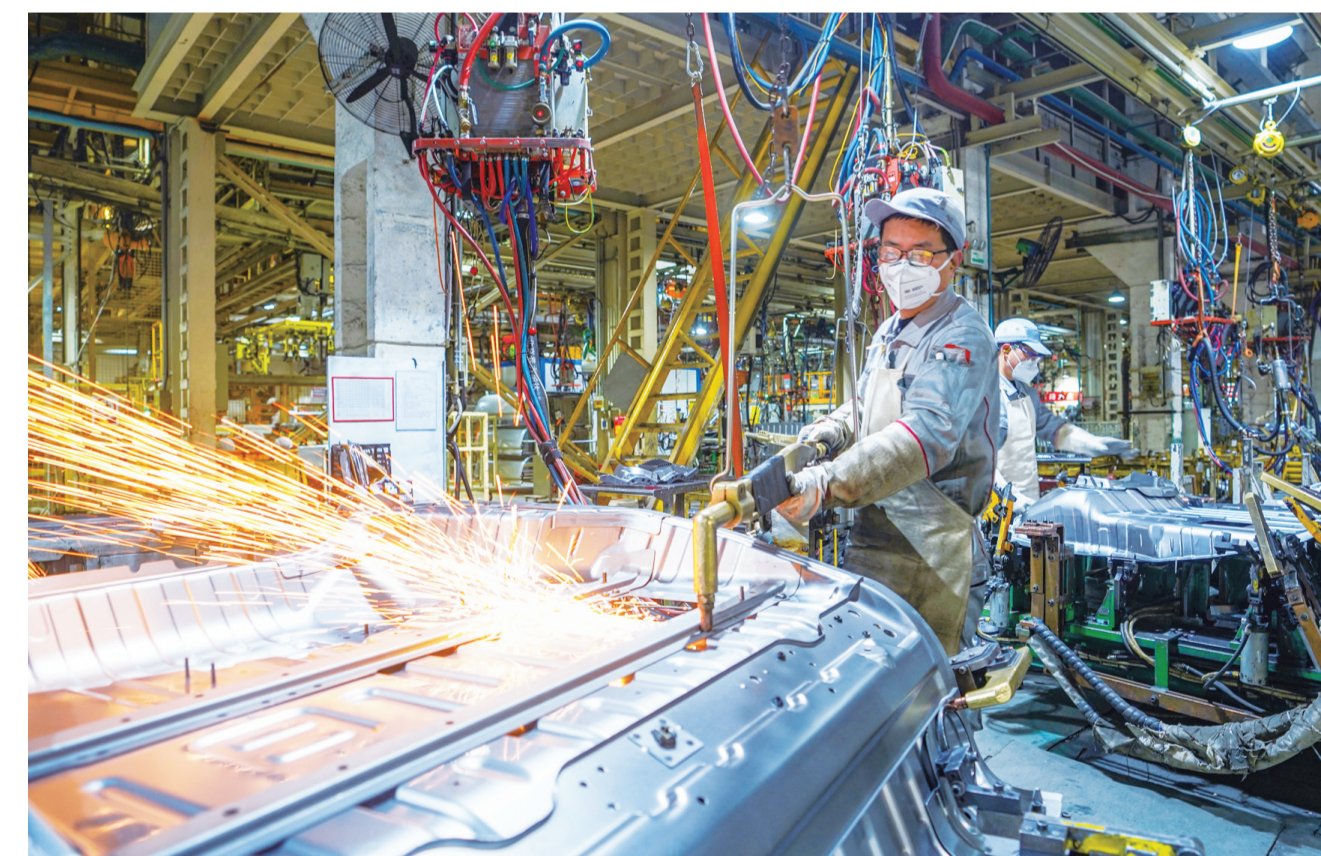
右图为东风商用车有限公司车身厂工人正在焊接汽车车身。
