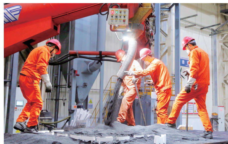
3月1日,在东风零部件集团通用铸锻分公司生产车间,工人正在操作机械设备进行填砂造型。开年以来,该公司保持满负荷生产,全力以赴赶订单。截至目前,已浇注铁水近3000吨。 记者金正 通讯员翁天华 摄
