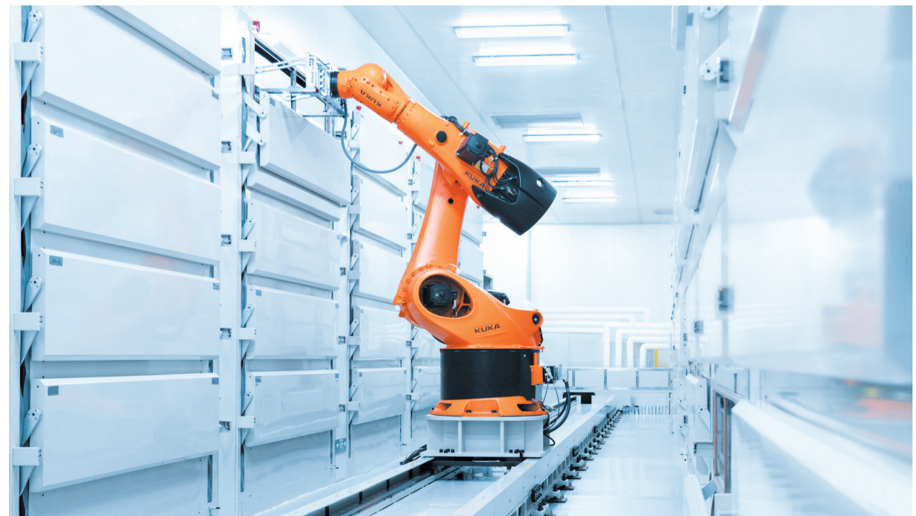
在远景动力十堰基地智能生产线上,机械手正抓取电芯进入烘烤流程。
