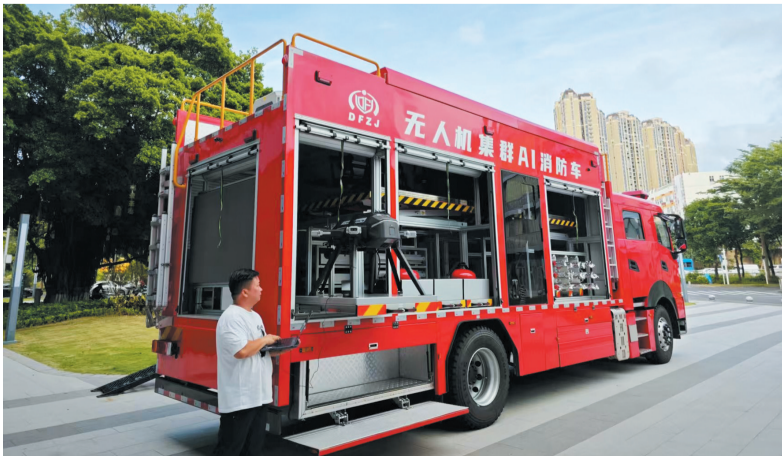
深圳东风(十堰)汽车有限公司制造的无人机集群AI消防车。
