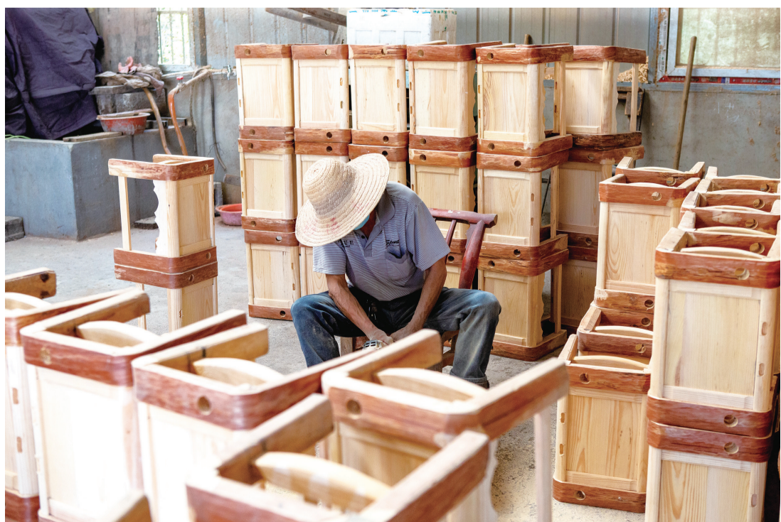
木椅全靠榫卯结构衔接,各个部件必须严丝合缝,柯昌清正仔细检查组装好的木椅的紧密性。
