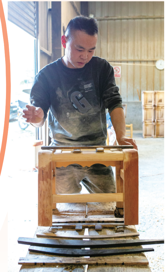
柯权向记者介绍用于木椅榫卯打孔定位的工具。
