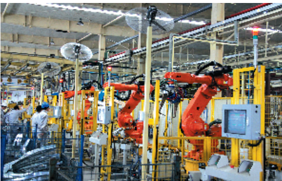
东风(武汉)实业公司先进的焊接机器人生产线
