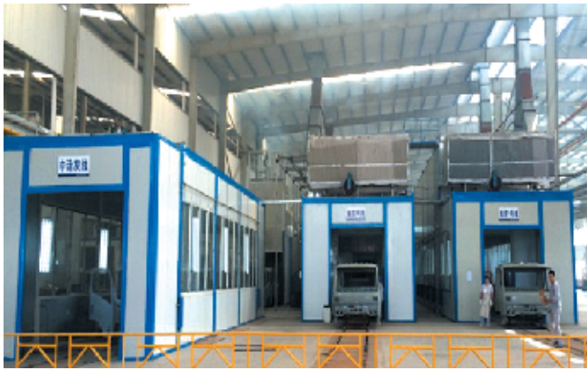
公司采用国际先进的阴极电泳涂装生产工艺
