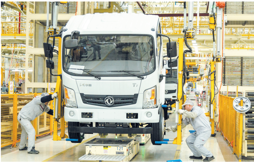
东风华神重点打造全球领先的油电混流小批量、多品种混流生产线,可实现传统油车和新能源车混流混线生产。 记者刘昆 摄
