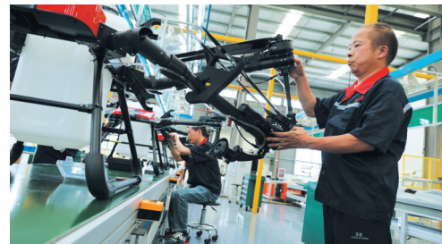
中翼通航(十堰)科技有限公司工人赶制无人植保机。
