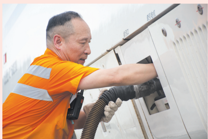
高铁十堰东站工作人员在进行吸污作业。记者赵琳玉 摄
