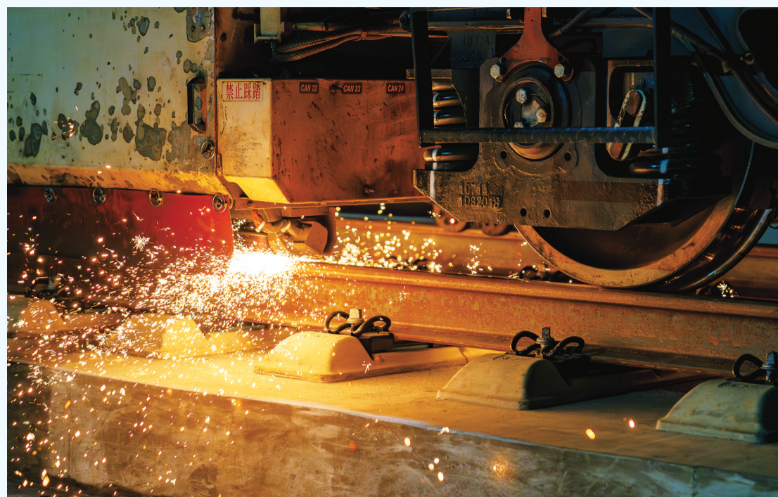
打磨车磨头与钢轨摩擦飞溅出火花。记者刘昆 摄
