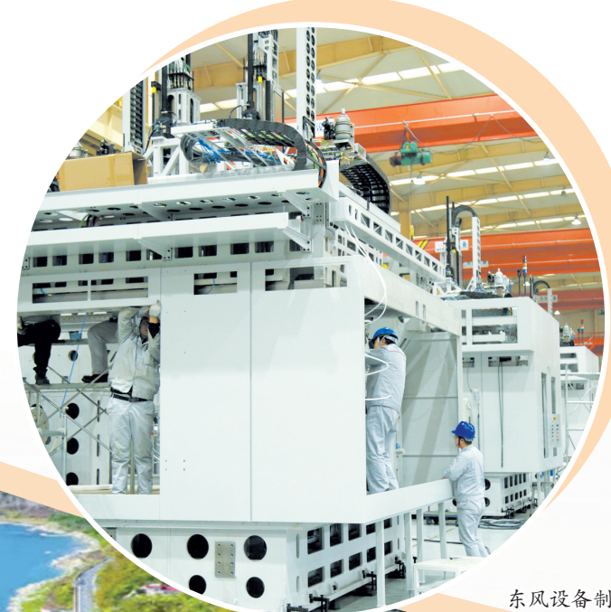
东风设备制造有限公司技术人员正在装配自主研发的DD64000芯横梁超高龙门五轴加工中心。记者刘昆 摄
