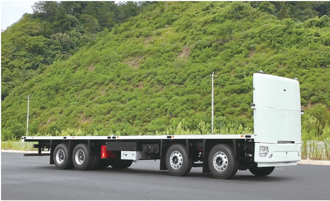
由宝路汽车自主研发的L4.5级无人驾驶商用物流车加紧开展多场景模拟测试。
