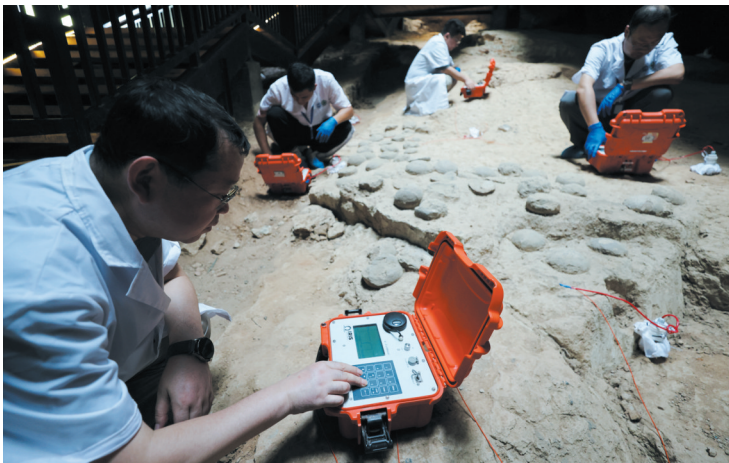
▲科研团队在青龙山恐龙蛋化石群遗址馆内进行IRIS-FW全波形激电仪信号接收前调试和电极定位检查。记者全正 摄 ▲科研团队在青龙山恐龙蛋化石群遗址区布设电极电缆和进行电极定位。 记者全正 摄
